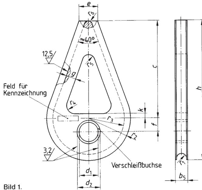
Bezeichnung einer Kausche für Rundseile für 17 t Nennlast und Seilennendurchmesser von 41 bis 45 mm:
